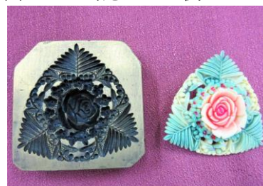
図10 対応金型の例
