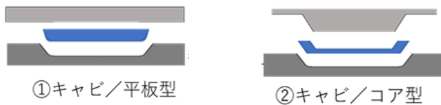
図4 圧搾成形品の金型(断面)
