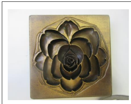
図 1 圧搾成形用金型
