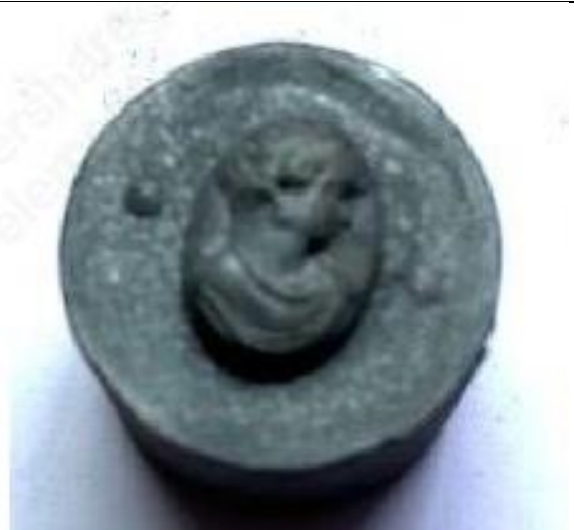
No.6 砲金製圧搾成形用金型 女性像 (陰)
