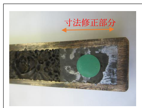
図 5 腕輪金型端部
