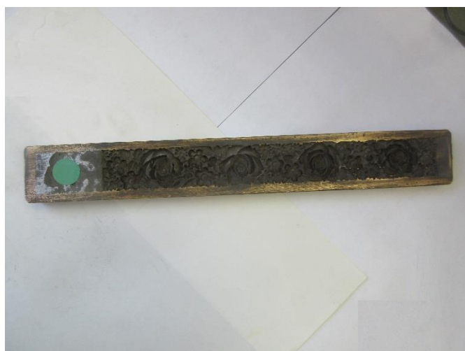
No.17 砲金製圧搾成形用金型 腕輪 (陰)
