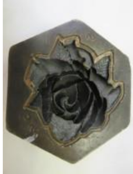
No.8 砲金製圧搾成形用金型 ばら (陰)
