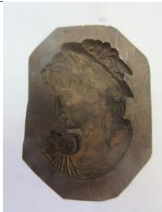
No.6 砲金製圧搾成形用金型 女性像 (陰)
