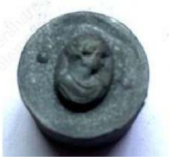
N° 6 Moule pour la compression en métal à canon, l'image féminine (négative)
