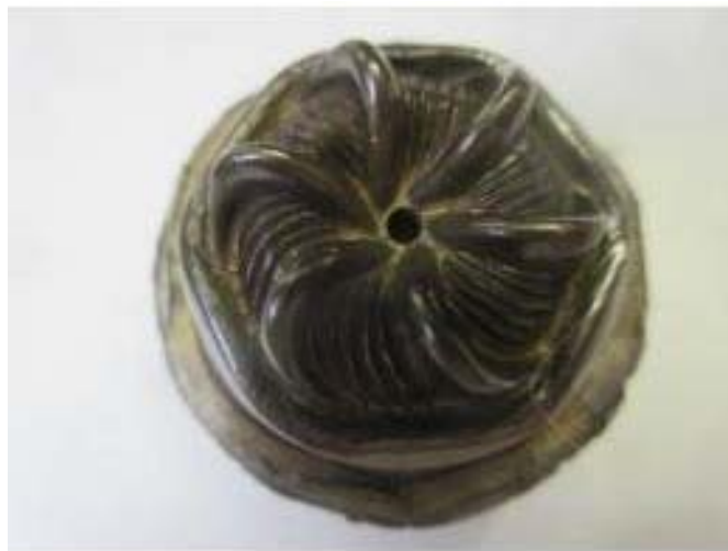
N° 9 Modèle maître en métal à canon hexagonal (positive)
