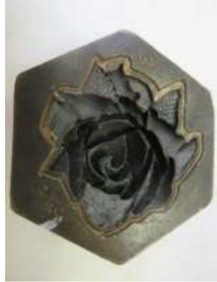
N° 8 Moule pour compression. Rose en métal à canon (négative)
