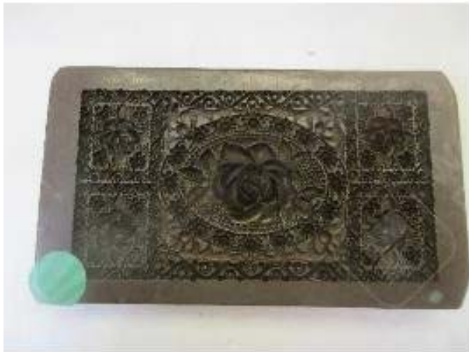
N° 15 Moule pour compression. Plaques carrées de rose (négative)
