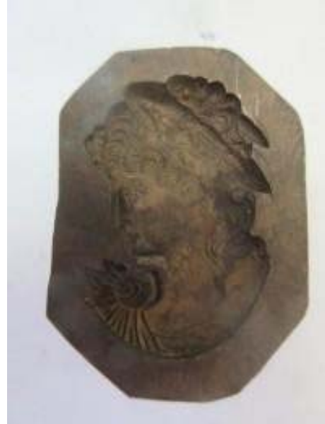
N° 6 Moule pour la compression en métal à canon, l'image féminine (négative)
