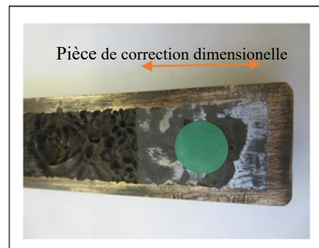
La figure 5: Extrémité du moule du bracelet
