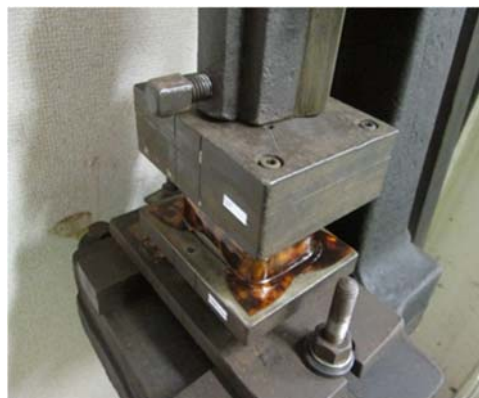
図3 プレスに金型を取り付けた状態
