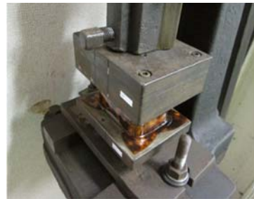
Fig. 3 : État lorsque le moule est fixé à la presse
